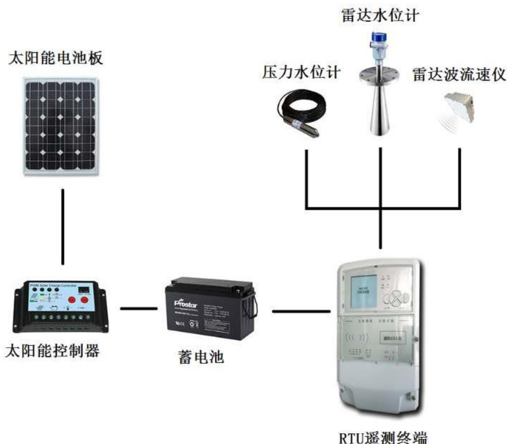
图 1.7-4 遥测终端站结构图
